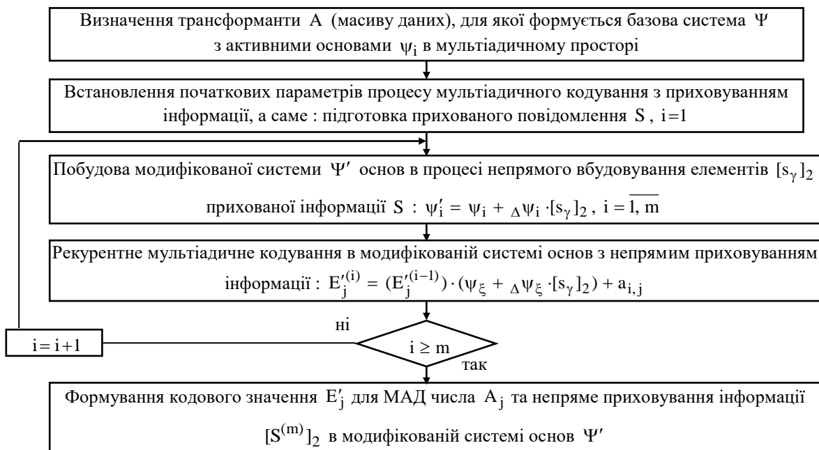
Рис. 2. Структурно-функціональна схема кодування в стеганографічній мультіадичній системі непрямого вбудовування інформації
