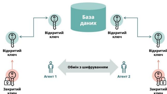
Рис.1. Використання технології шифрування з відкритим ключем в межах технології блокчейн
