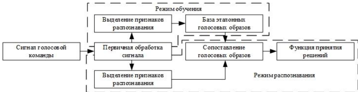
Рис. 1. Функциональная схема системы распознавания голосовых команд управления БПЛА на основе кепстрального анализа
