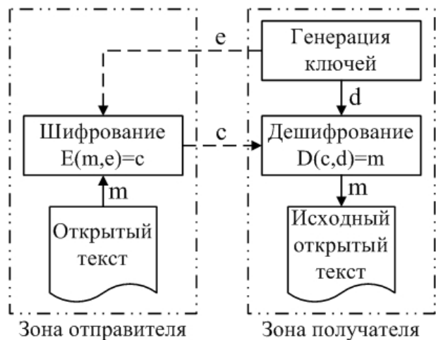
Рис. 2. Принцип работы асимметричных систем шифрования
