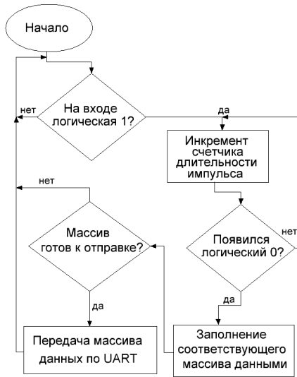
Рис. 10. Алгоритм работы МК в схеме приемника РЛС
