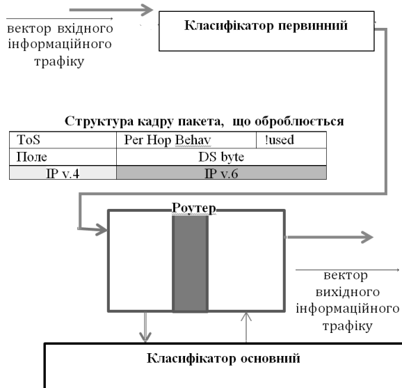
Рис. 3. Функціональна схема модифікованого методу фільтрації QoS-трафіку
