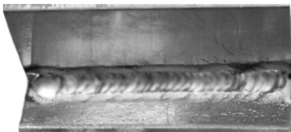
Рис. 2. Образец сварного таврового соединения толщиной 5 мм, полученного при следующих значениях факторов: X 1 =2 мм, X 2 =110А
