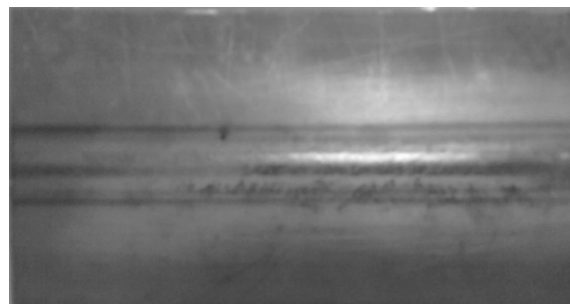
Рис. 3. Образец сварного стыкового соединения толщиной 3 мм, полученного при следующих значениях факторов: X 1 =1 мм, X 2 =70А
