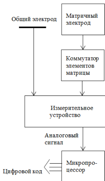
Рис. 1. Структура измерительного тракта устройства для электропунктурной диагностики
