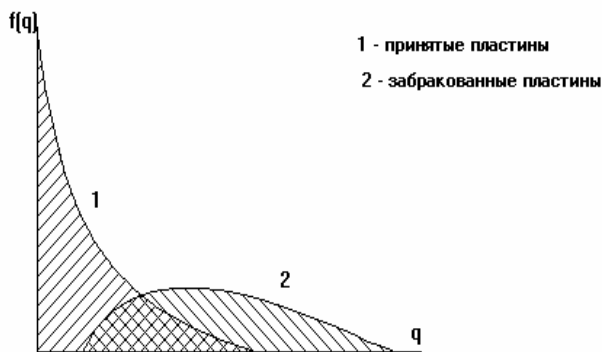
Рис. 2. Плотность распределения пластин от величины прогнозируемого брака
