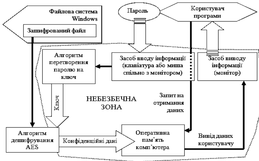
Рис. 2. Структурна схема відновлення конфіденційної інформації
