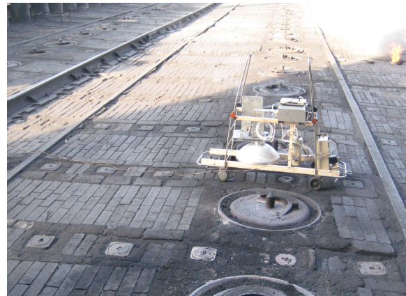
Рис. 3. Измерение температур вдоль и поперек простенка
