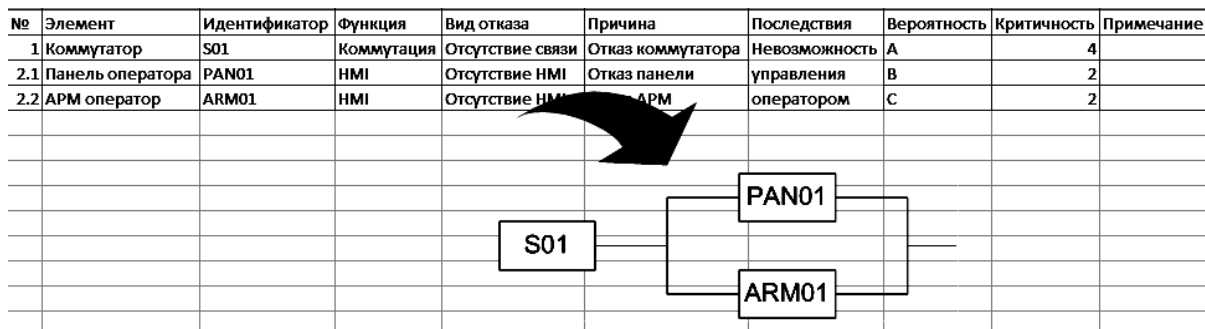
Рис. 2. Построение блок-схемы надежности по FMECA-таблице
