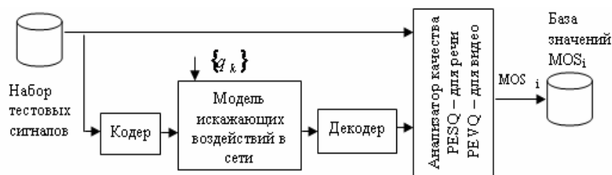
Рис. 4. Схема экспериментального определения значений сквозного качества пользовательского восприятия
