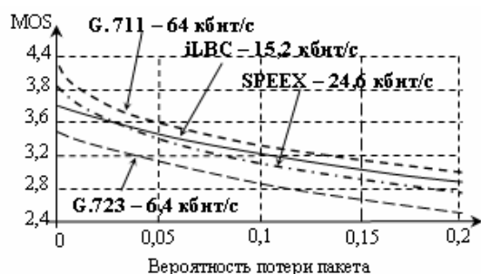
Рис. 5. Зависимость MOS от вероятности потери пакета для различных кодеков речи [21]
