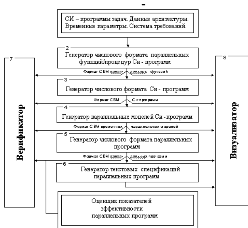
Рис.4. Архитектура технологии синтеза временных мультипараллельных программ
