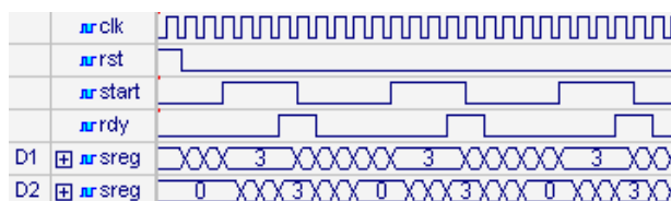
Рис. 8. Временная диаграмма изменения состояний (sreg) двух автоматов
