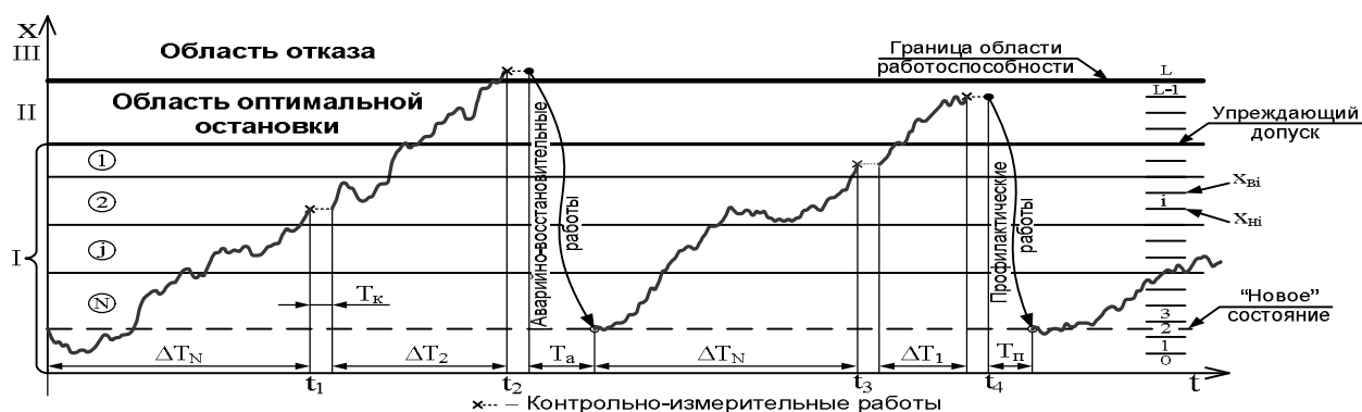
Рис. 1. Принцип эксплуатации по состоянию при отсутствии мгновенной индикации отказа
