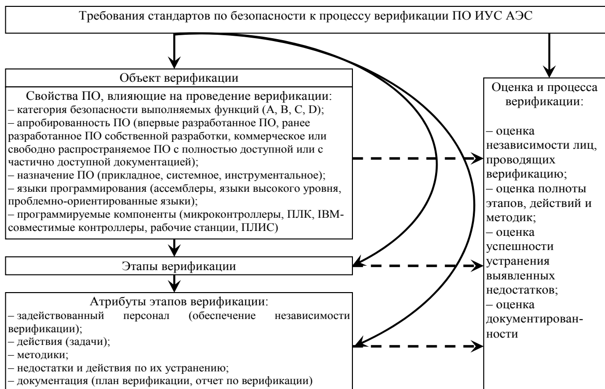
Рис. 2. Обобщенная структура процесса верификации ПО ИУС АЭС
