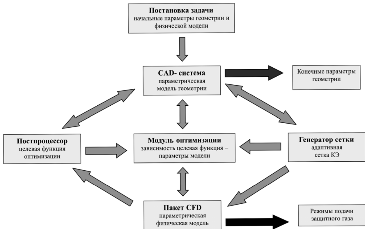
Рис. 6. Схема взаимодействия модулей CAD/CAE системы при решении задачи газодинамического проектирования катодных узлов
