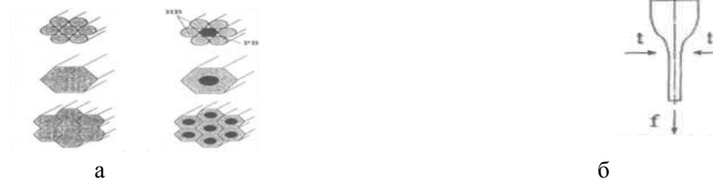
Рис. 3. Технология получения микроволоконных пучков: а – вариант упаковки волокон в пучок; б – перетяжка пучка
