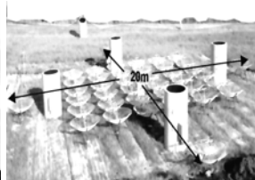
Рис. 12. Система РАЗ: поле радиоантенн с акустическими источниками вокруг (CRIEPI)
