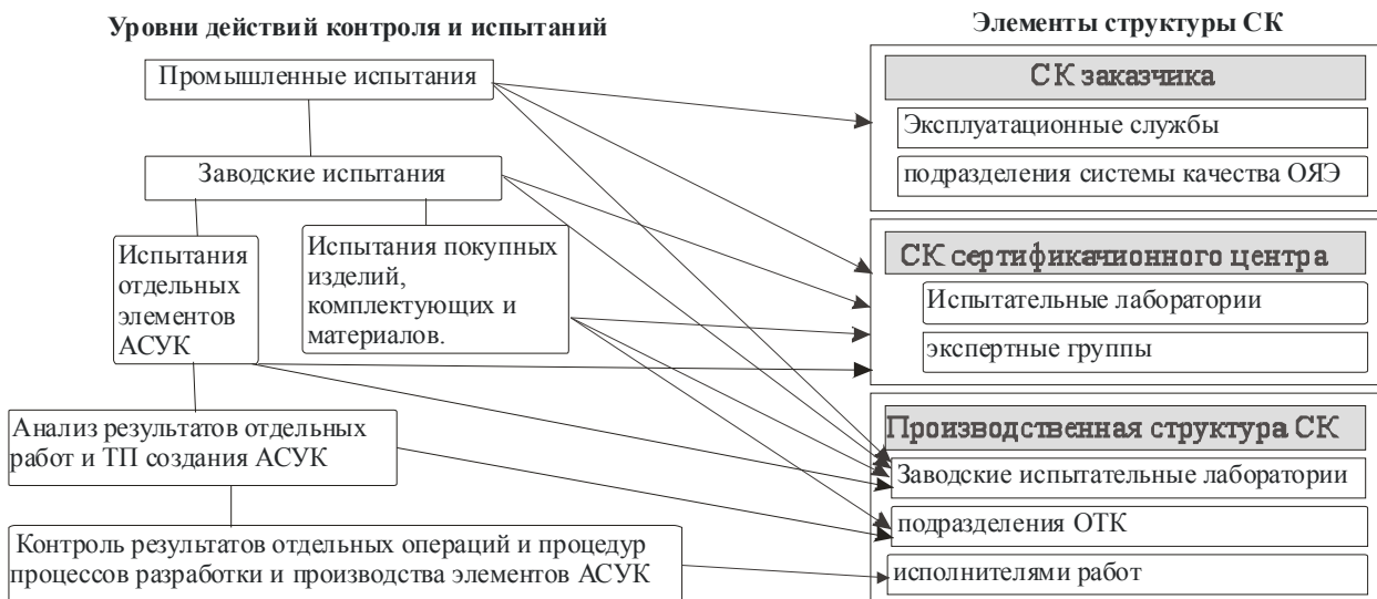
Рис .2. Взаимодействие иерархии процессов контроля и испытаний с элементами структуры СК
