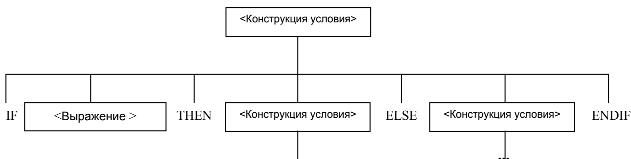
Рис. 3. Пример конструкции условия в виде дерева разбора
