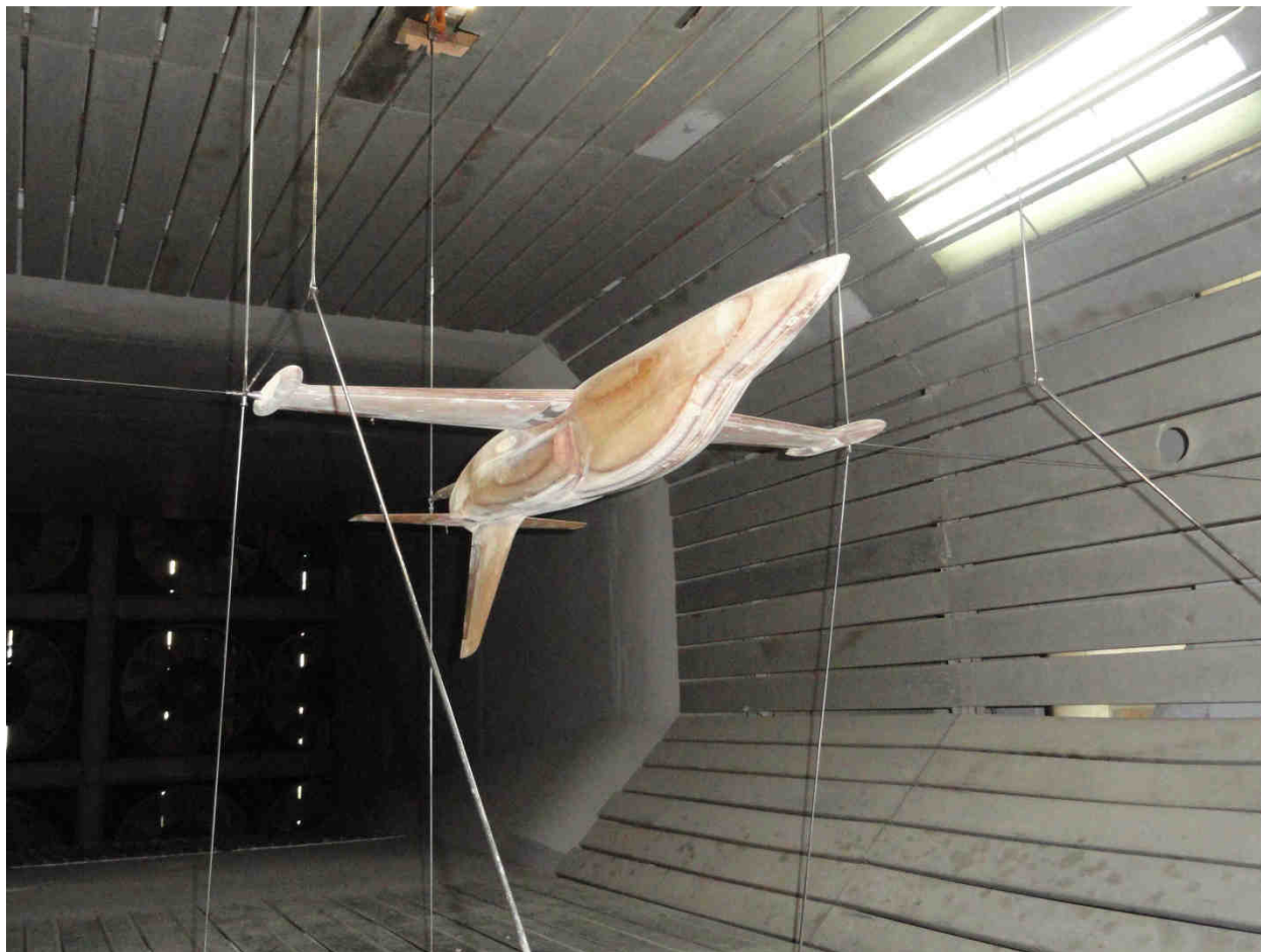
Рис. 8. Модель на подвеске весов для продувок на углах атаки \pm 30^\circ .
