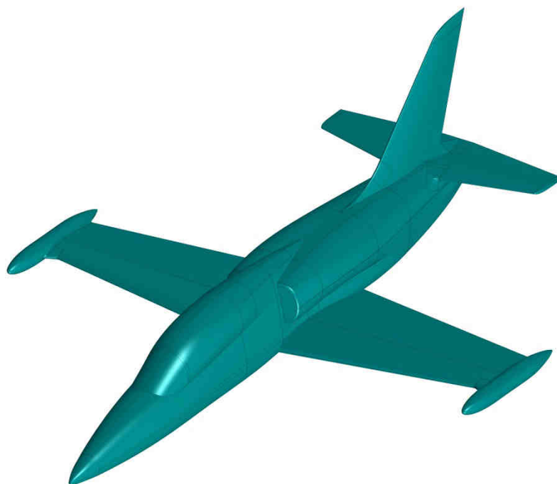
Рис. 2. Аналитический эталон теоретических поверхностей самолета Л-39
