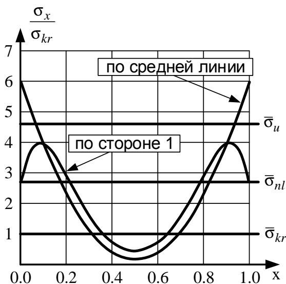
Рис. 4. Распределение относительных напряжений в поперечном направлении
