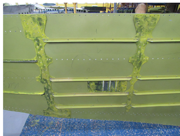
Рис.6. Повреждения внутреннего силового набора обшивки левого стабилизатора. Селективная коррозия: глубина повреждений 0,3...0,6 мм, материал Д16Т, толщина 1,0 мм
