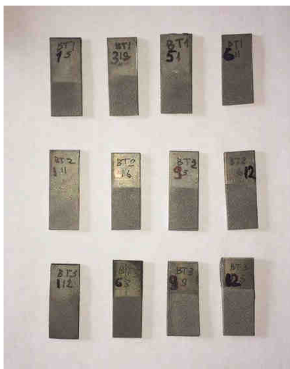
Рис. 2. Подложки из титановых сплавов BT1-0, BT22, BT3-1
