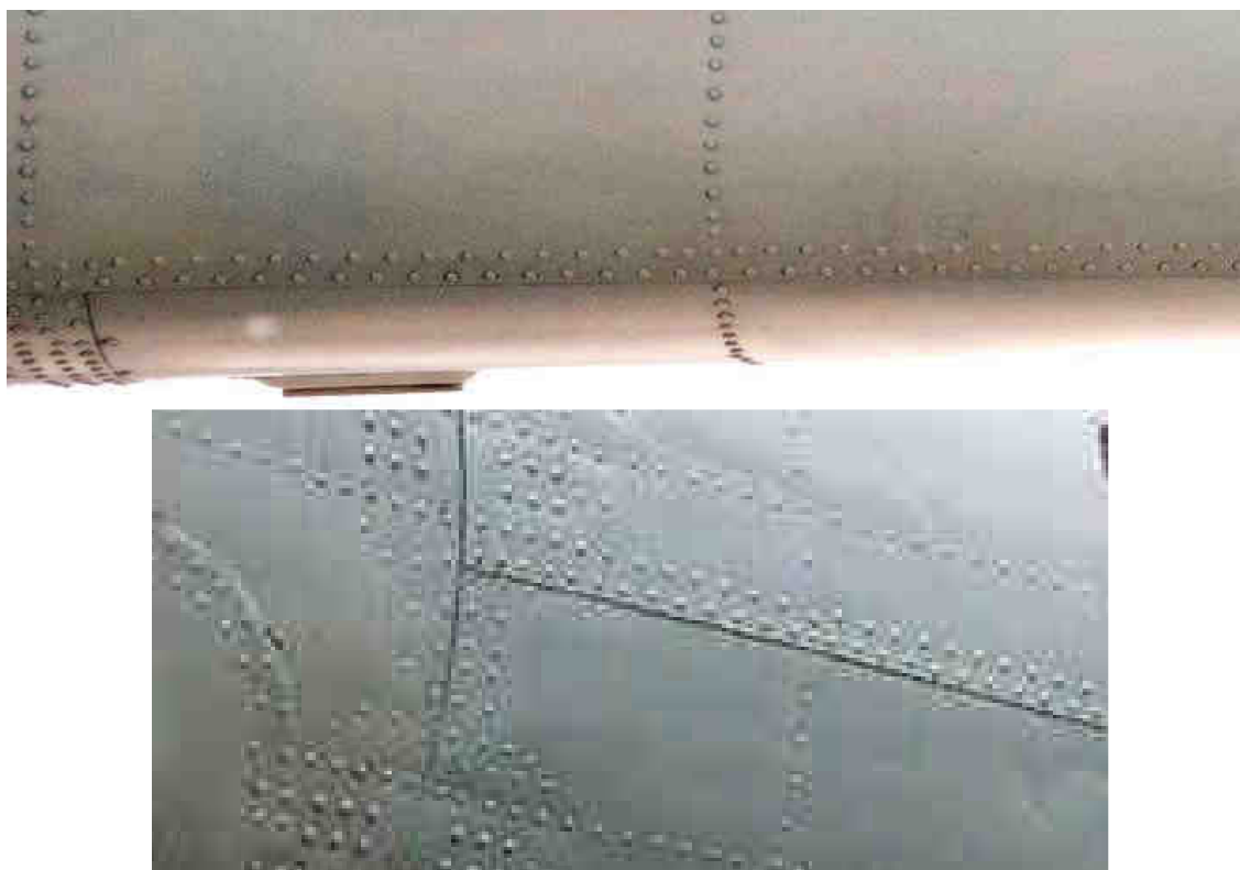
Рис. 1. Заклепочные соединения листов обшивки ХБ
