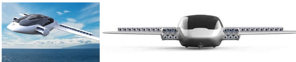
Рис. 10. Электрический конвертоплан компании Lilium
