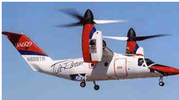
Рис. 2. Конвертоплан гражданского назначения с поворотными двигательными установками BA609
