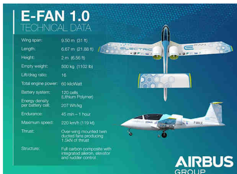
Рис. 3. Схема спортивно-пилотажного самолета Airbus "E-Fan"
