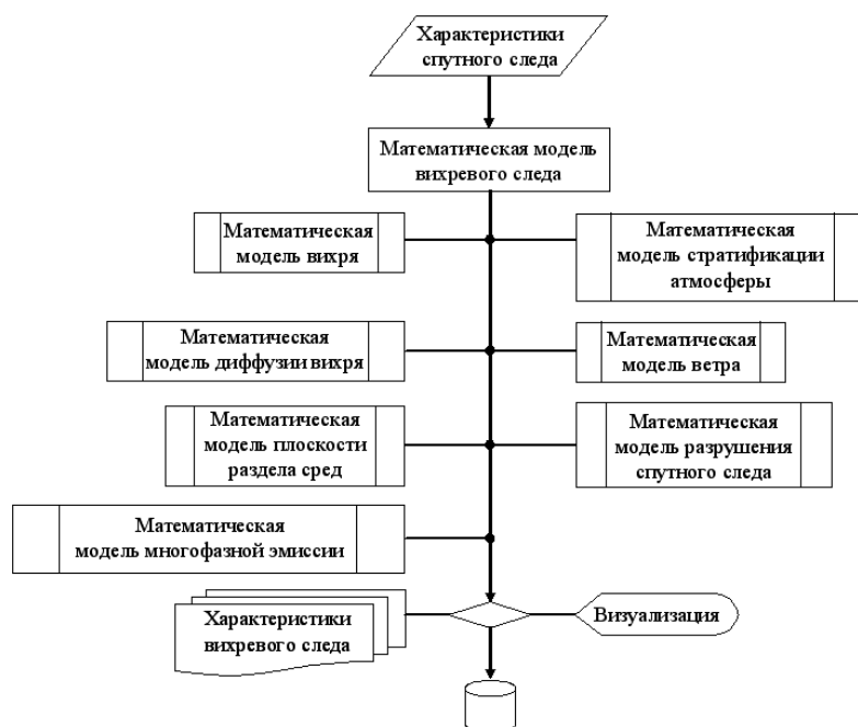
Рис. 3. Методика расчёта характеристик вихревого следа
