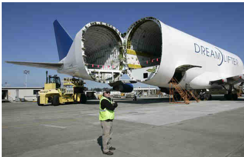
Рис. 9 Самолет Boeing 747LCFDreamlifter с задней отъемной частью
