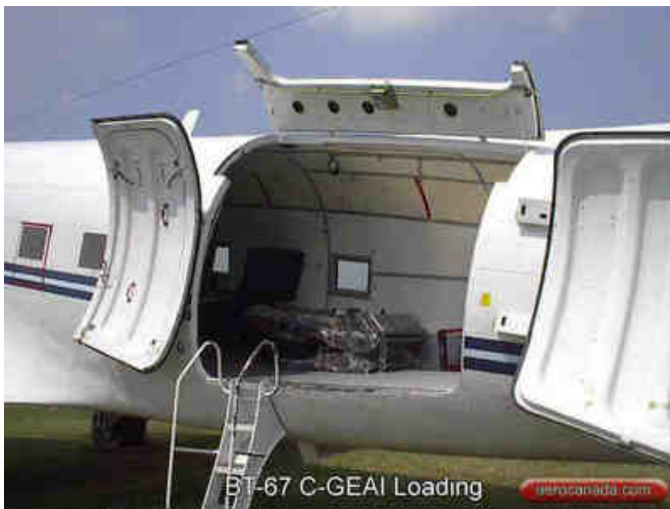
Рис. 11. Самолет Basler BT-67 с многостворочным боковым грузовым люком
