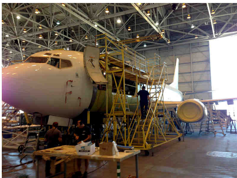
Рис. 2. Переоборудование пассажирского Boeing 737-400 в транспортный Boeing 737F
