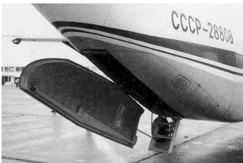
Рис. 14. Самолет Ан-28 с двухстворочным задним грузовым люком
