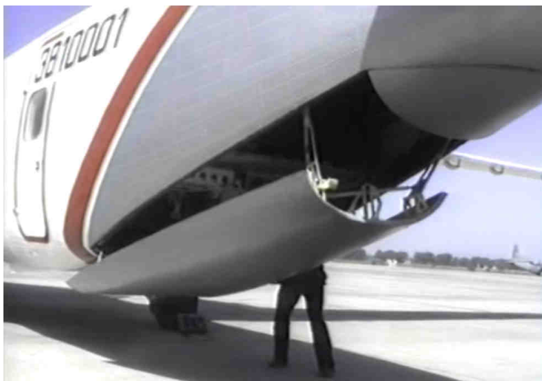
Рис. 13. Самолет Ан-38 с одностворочным задним грузовым люком
