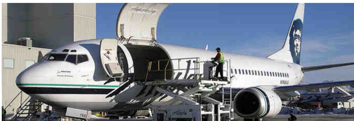
Рис. 3. Пример погрузки при помощи специальной аэропортовой погрузочной платформы
