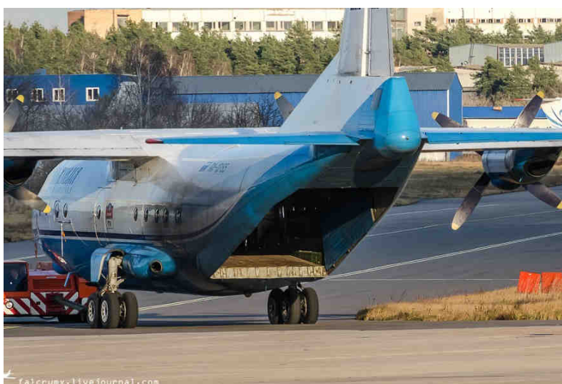
Рис. 15. Самолет Ан-12 с многостворочным задним грузовым люком
