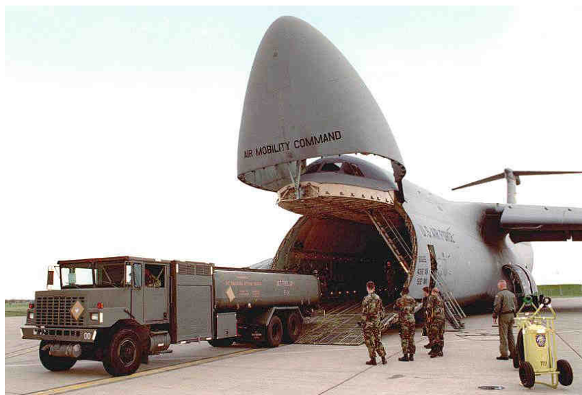
Рис. 7. Самолет C-5 Galaxy с комбинированным передним грузовым люком
