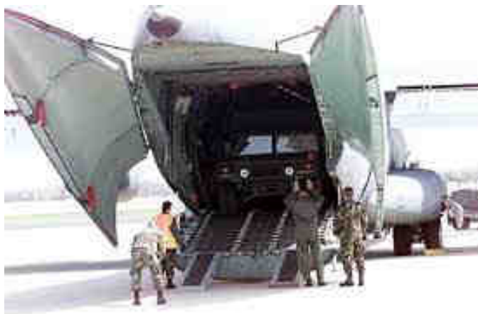
Рис. 16. Самолет С-141 с двухстворочным задним комбинированным грузовым люком
