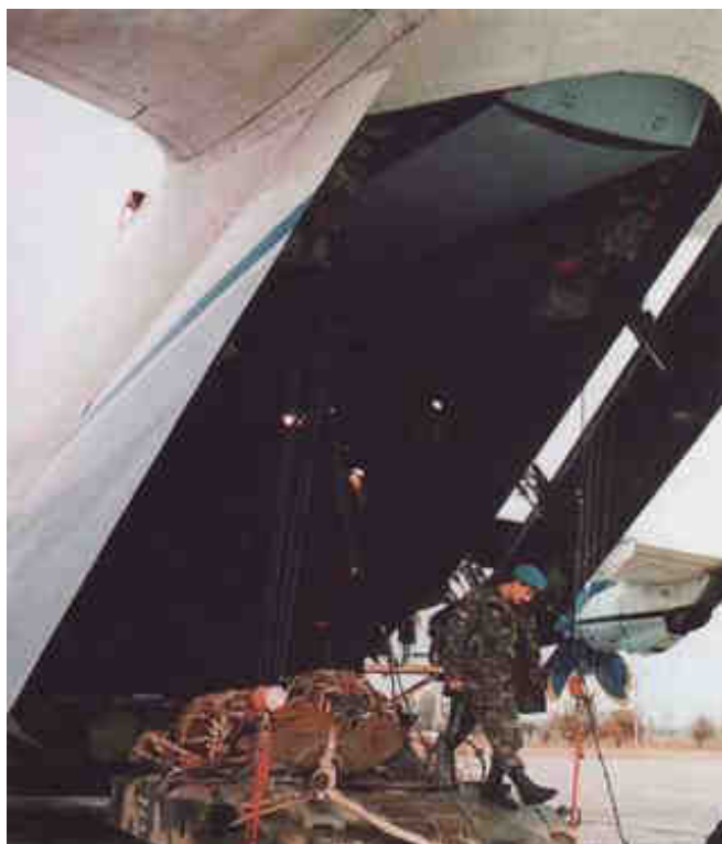
Рис. 17. Самолет Ан-70 с многостворочным задним комбинированным грузовым люком
