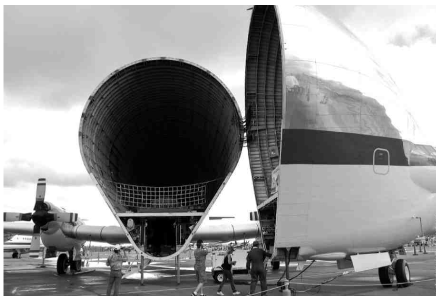
Рис. 6. Самолет Boeing 377 SuperGuppy с передней отъемной частью
