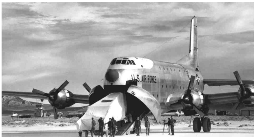
Рис. 12. Самолет C-124 с двухстворочным передним грузовым люком
