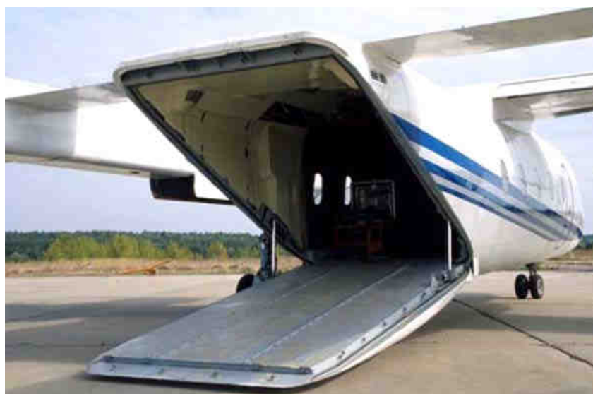
Рис. 8. Самолет Су-80 с рамповым задним грузовым люком
