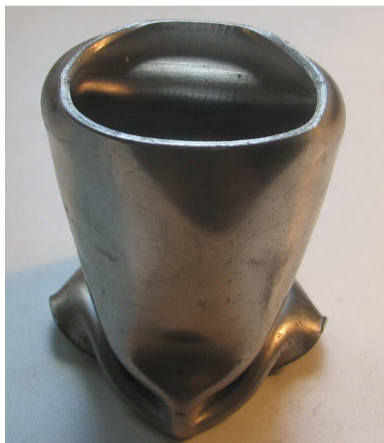
Рис. 7. Формообразование продольных гофров при дальнейшем увеличении нагрузки на образец
