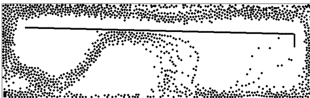
Рис. 5. Возникновение паразитических вихрей. Влет – в правом верхнем углу, вылет – в левом нижнем. Препятствие – сплошная линия
