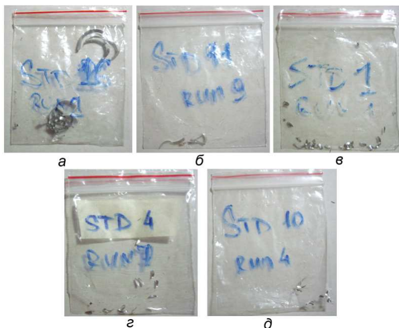
Рис. 5. Вид стружки нежелательного происхождения
