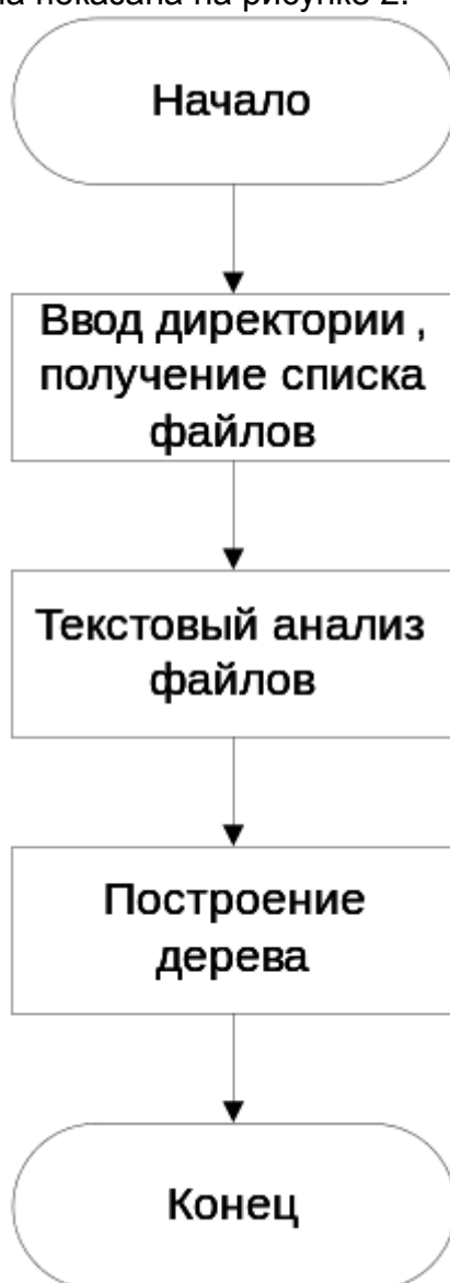
Рис. 2. Блок-схема алгоритма функционирования инструментального средства построения дерева классов
