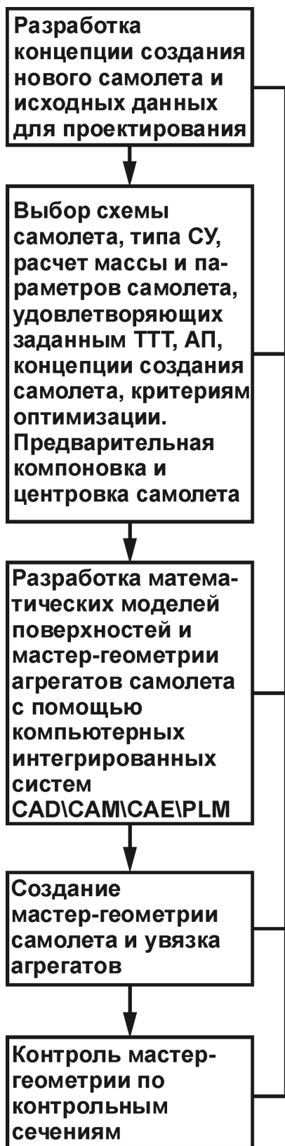
Рис. 4. Метод створення майстер-геометрії літака за допомогою комп'ютерних інтегрованих систем
