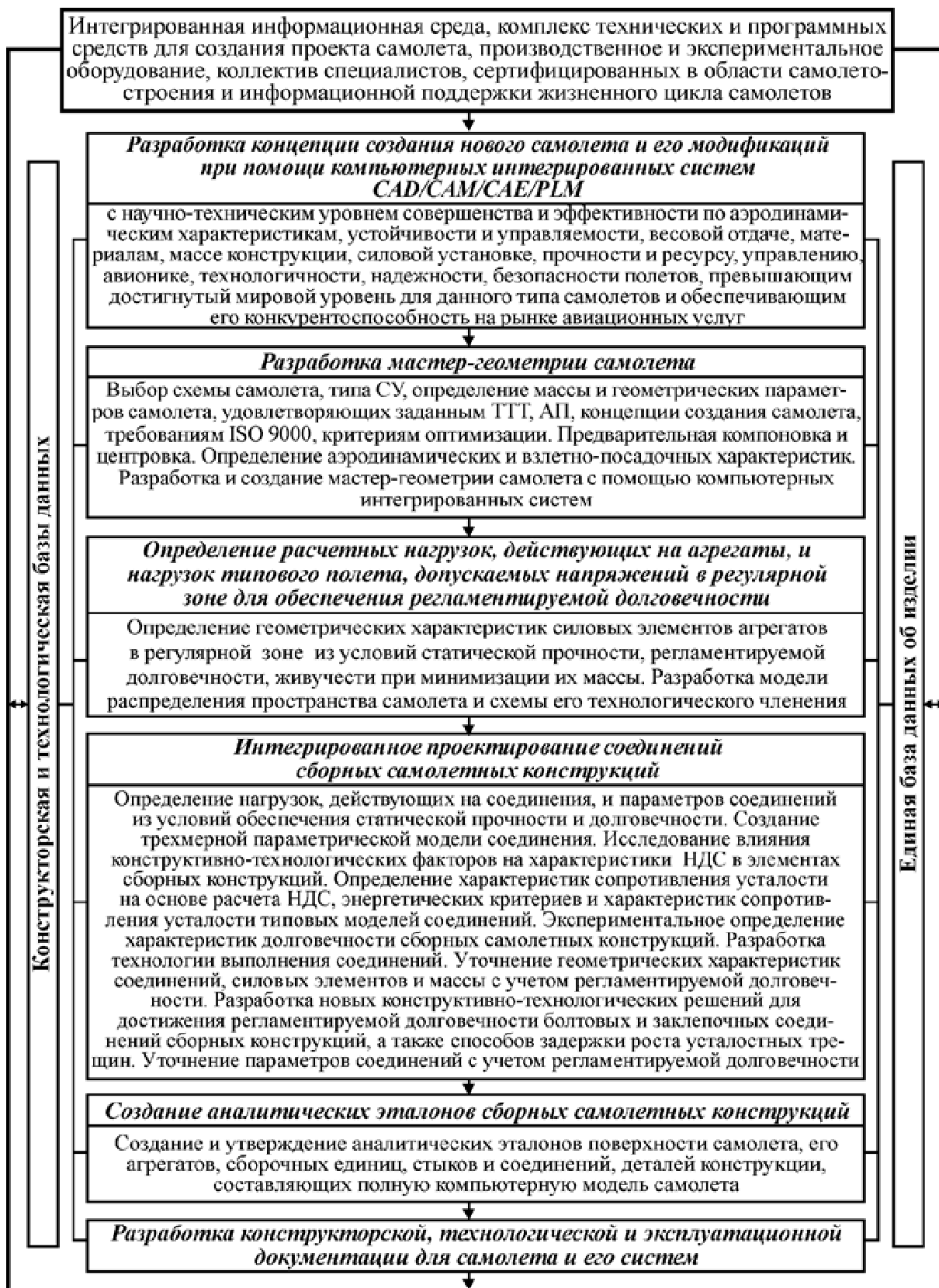
Рис. 3. Нова концепція інтегрованого проектування збірних літакових конструкцій
