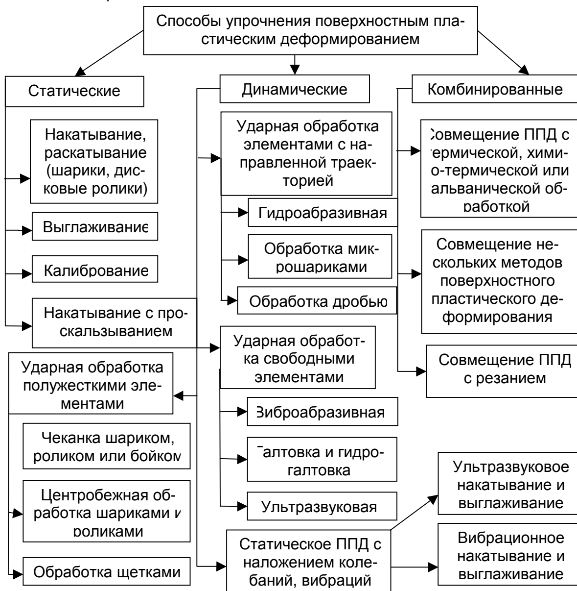
Рис. Классификация способов поверхностного пластического деформирования
