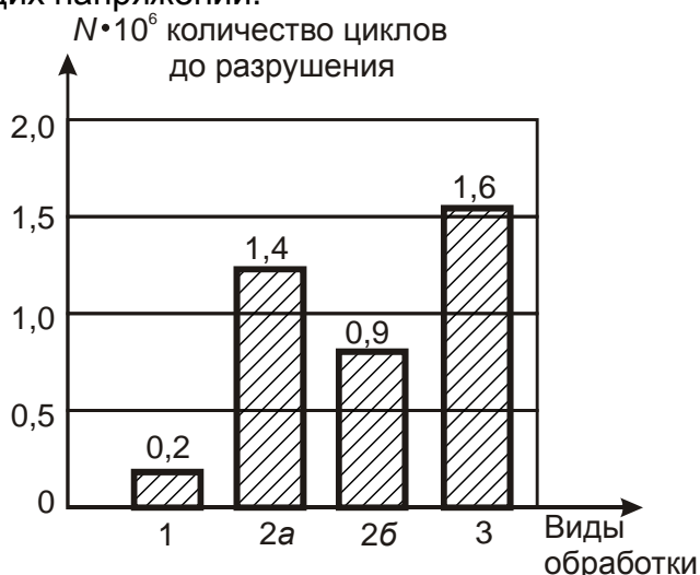
Рис. 6. Диаграмма усреднённых показателей усталостных испытаний Д16-Т: 1 — фрезерование; 2a — виброударная обработка, T = 40 мин; 2б — виброударная обработка, T = 20 мин; 3 — дробеструйная обработка
