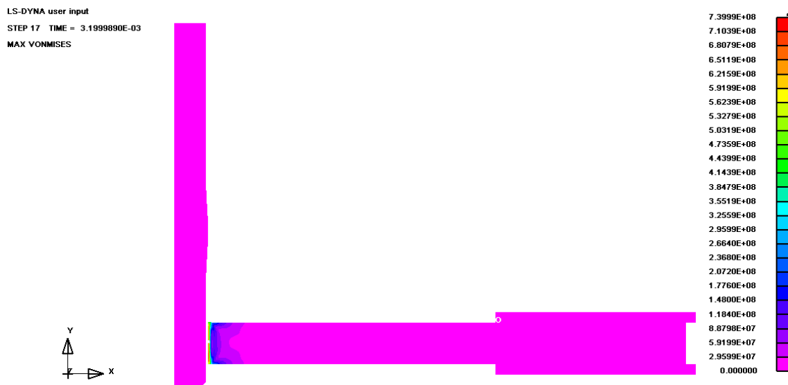
Рис. 2. Конечно-элементная модель деформации в зоне отверстия после прямого и реверсного скоростного дорнования
