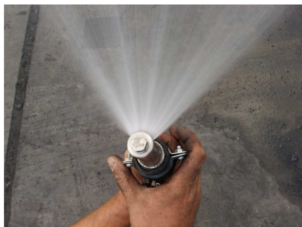
Рис. 4. Розпилювач віялового типу
