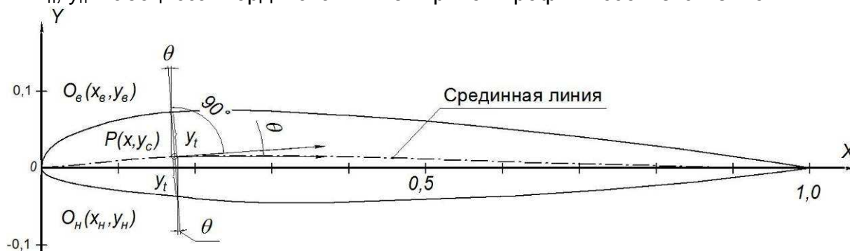
Рис. 9. Геометрическое построение профиля NACA
