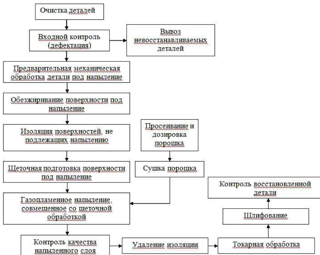
Рис. 1. Технология восстановления детали типа плунжер интегрированным газопламенным напылением со щеточной обработкой
