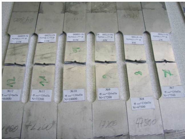
Рис. 2. Типичный характер разрушения образцов различных партий
