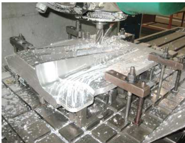
Рис. 4. Процесс изготовления серийного кронштейна на станке ФП-7СМН5
