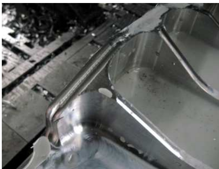
Рис. 5. Подрезание поверхности детали в углах «колодцев»
