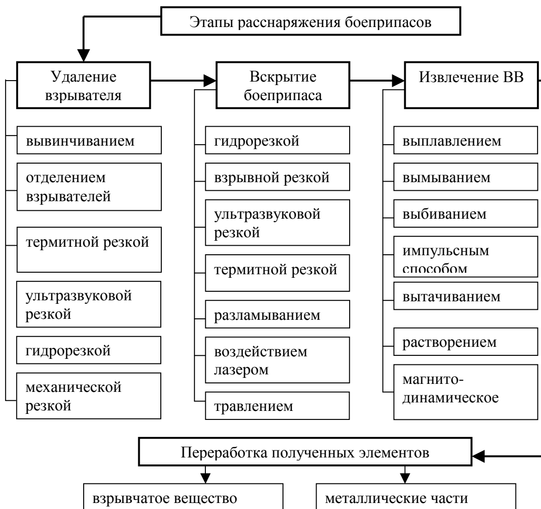
Рис. 2. Схема этапов утилизации боеприпасов
