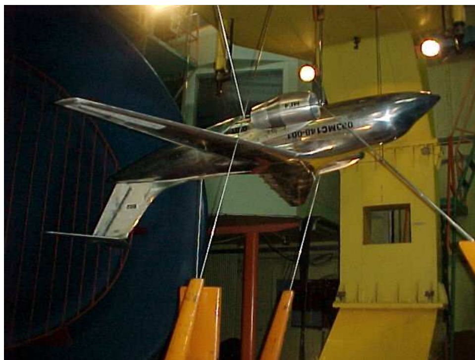
Рис. 1 Механизированная модель самолета Ан-148 в рабочей части АТ-1
