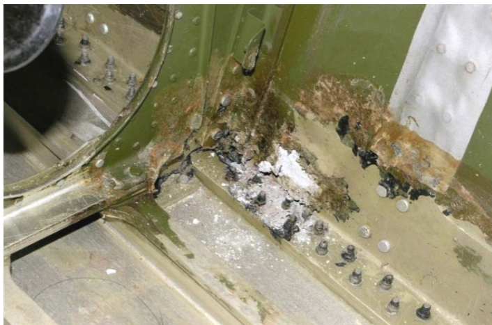
Рис. 1. Очаг расслаивающей коррозии вертикальной полки нижнего пояса I лонжерона центроплана у 3 нервюры крыла слева, обнаруженный на самолете Ан-26 после 13 лет эксплуатации в условиях влажных тропиков.
