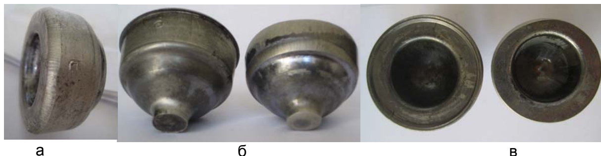
Рис. 5. Экспериментальные поковки: а – после первого перехода штамповки из исходной заготовки; б, в (слева) – за два перехода штамповки; б, в (справа) – за один переход из исходной заготовки
