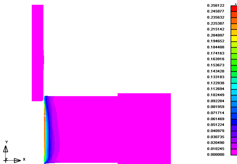
Рис. 4. Конечно-элементная модель деформации в зоне отверстия после прямого и реверсного скоростного дорнования
