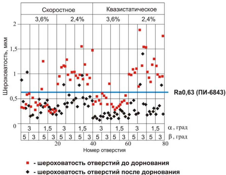
Рис.16. Шероховатость отверстий до и после квазистатического и скоростного дорнования
