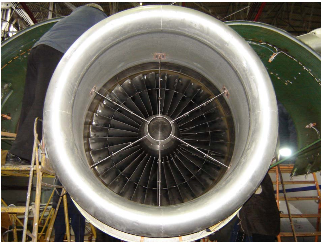
Рис. 2. Установка гребенок приемников давления в воздухозаборнике
